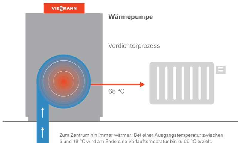
Ein Wärmetauscher überträgt die Energie aus dem erwärmten Gas an den Heizkreislauf. Dabei verflüssigt sich das noch unter Druck stehende Kältemittel wieder und wird in einem Expansionsventil entspannt. Dann beginnt der Kreislauf von vorne.
