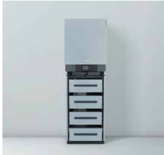
Die Vitocharge Stromspeicher-Unit ist modular aufgebaut. Bis zu vier Batteriemodule lassen sich nach dem Schubladenprinzip einschieben und nehmen automatisch ihren Betrieb auf.
