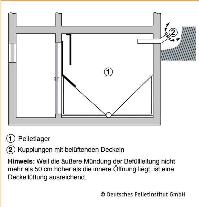
Abb. 28: Belüftungslösung für Pelletlager mit Befüllstutzen im Lichtschacht
