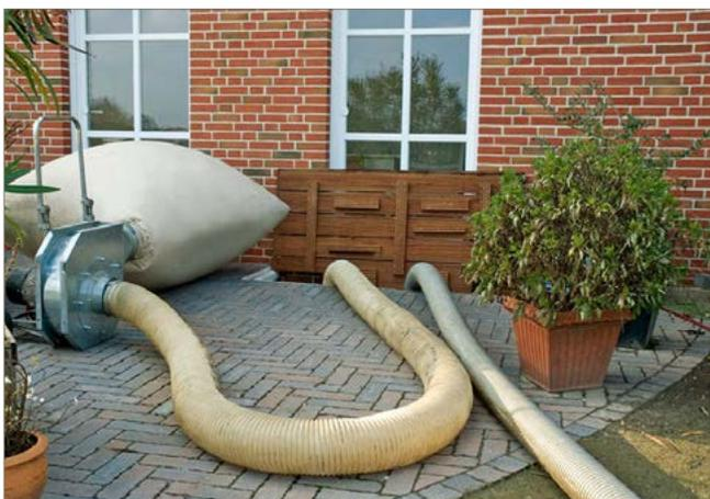
Abb. 4: Absaugventilator mit Staubsack
