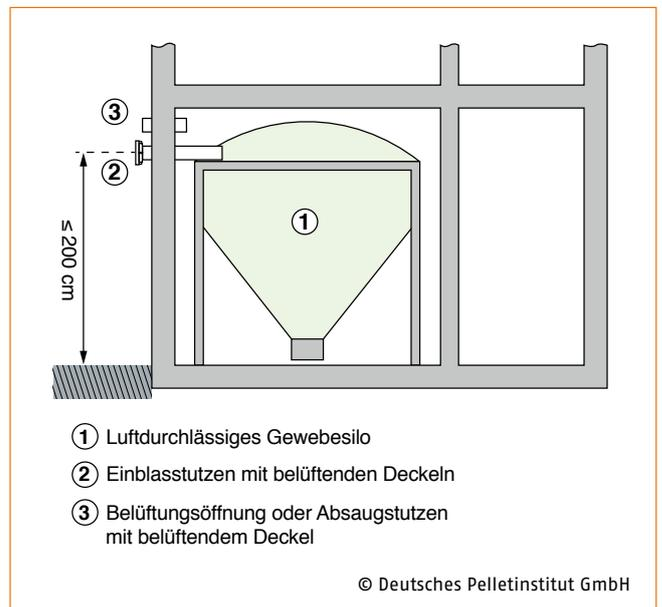
Abb. 13: Belüftungslösung für luftdurchlässige Gewebesilos ohne Absaugstutzen im Heizraum mit nach außen geführten Befüllstutzen
