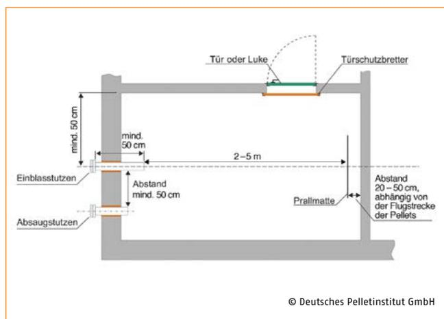
Abb. 18: Grundriss eines Pelletlagerraums (Lüftung über Befüllsystem)
