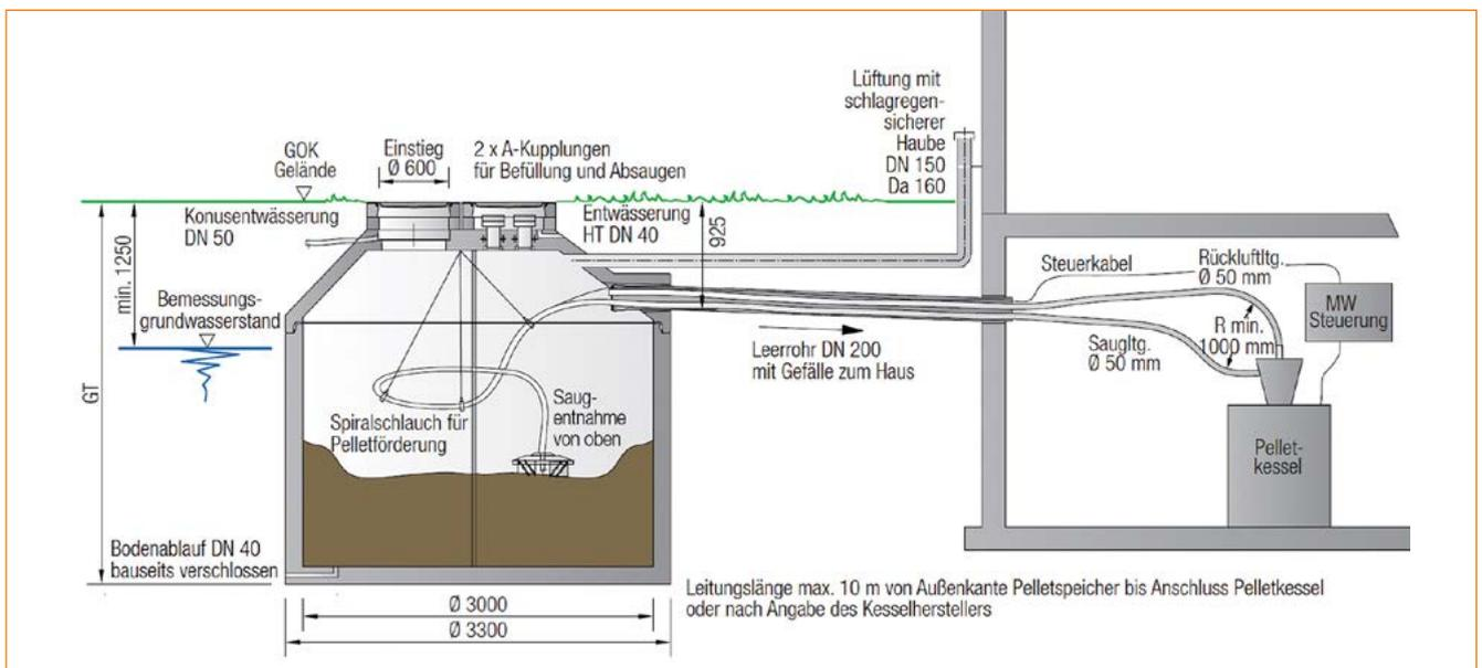
Abb. 16: Erdlager aus Beton mit Saugentnahme von oben
