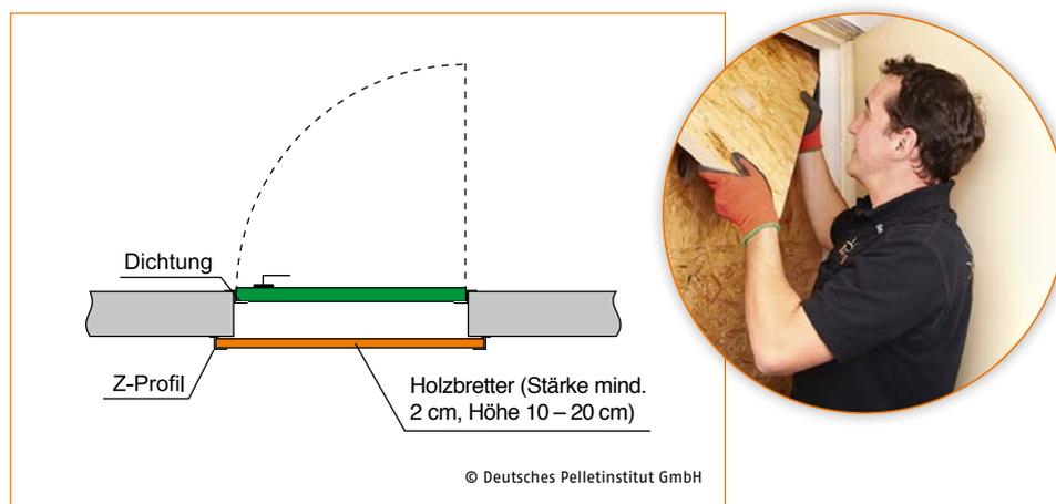
Abb. 19: Druckentlastung der Zugangstür/-luke bzw. Einstiegsöffnung (Draufsicht)
