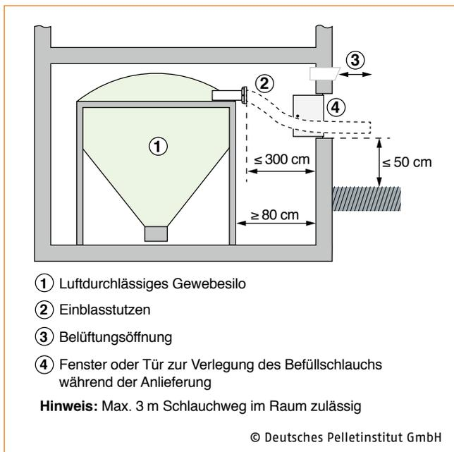
Abb. 15: Belüftungslösung für luftdurchlässige Gewebesilos ohne Absaugstutzen mit Befüllstutzen im Heizraum
